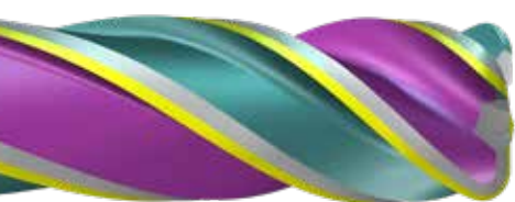
带差动螺旋、可变芯厚尺寸和恒定齿背宽的多螺旋立铣刀。
