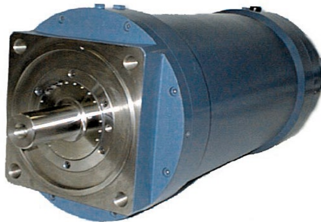
AMR mit Hybridkühlung: Flüssigkeitskühlung und Luftkühlung durch die Welle
