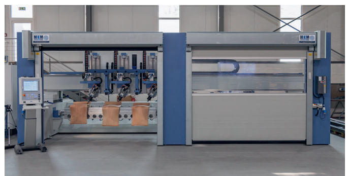
Innovative, 17-achsige Fräsmaschine für Stuhlsitze
