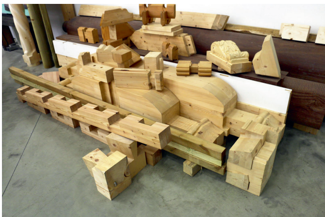
Beispielwerkstücke einer Abbundmaschine
