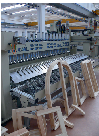
Maschine mit 64 Achsen zur Produktion von Fensterrahmen
