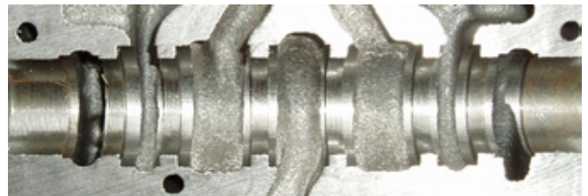
Unimerco一体化高效解决方案的典型实例——内孔成型槽铣刀加工工件之前和之后的效果对比。
