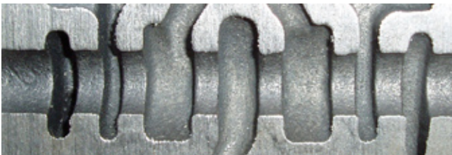
Unimerco一体化高效解决方案的典型实例——内孔成型槽铣刀加工工件之前和之后的效果对比。
