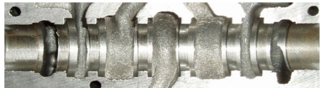
Ein typisches Beispiel einer effizienten Unimerco-All-in-one-Lösung – ein Profilwerkzeug (Grooving Land Tool) und die Vorher- und Nachher-Ergebnisse eines bearbeiteten Werkstücks
