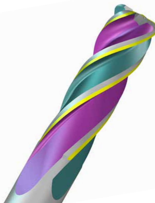
Figure 1 : Listel constant sur fraise torique avec multi spirale et hélice différentielle (diamètre du noyau variable)
