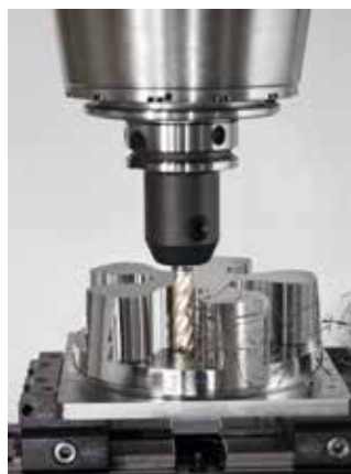
ConeFit 可换头式铣刀示例；于 2009 年面市，丰富了 Walter Prototyp 产品的多样性。
