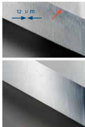
图 3 第一个齿面放大 200 倍的图像，上方为未修整的砂轮，下方为修整的砂轮
