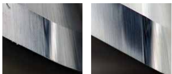
图 4 使用基恩士数码显微镜在 200 倍放大倍数下拍摄的圆弧与球体之间的过渡，左侧无可见痕迹，右侧可见痕迹
