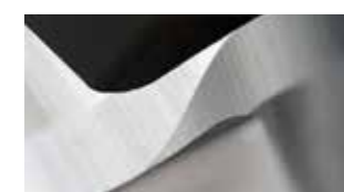
图 1 使用基恩士数码显微镜测量出的横向切削刃（放大倍数 200:1）
