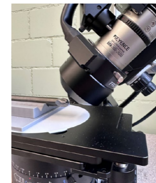
Messung der Schneidkante auf dem Vollradiusfräser unter 45°
