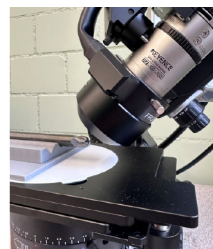
Mesure de l'arête de coupe sur la fraise à rayon complet sous 45^\circ
