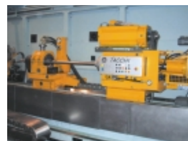
Secondo mandrino che permette di sostenere il pezzo per le operazioni di tornitura, o di sostenere e guidare l'utensile nelle operazioni di alesatura
