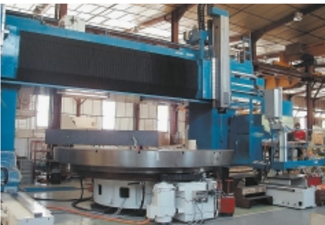
Macchina di tornitura e fresatura di Dufieux Industrie in montaggio con tavola di 4,5 m
