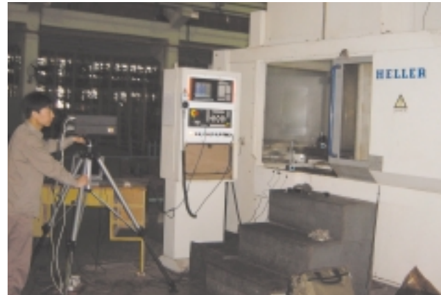
Die „alte“ Heller-Maschine von China Nanchang Aircraft Manufacturing Company erhielt eine neue Num Power 1060.
