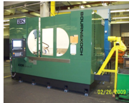
Wälzfräsmaschine 400H der Serie II von Bourn & Koch mit sieben CNC-Achsen
