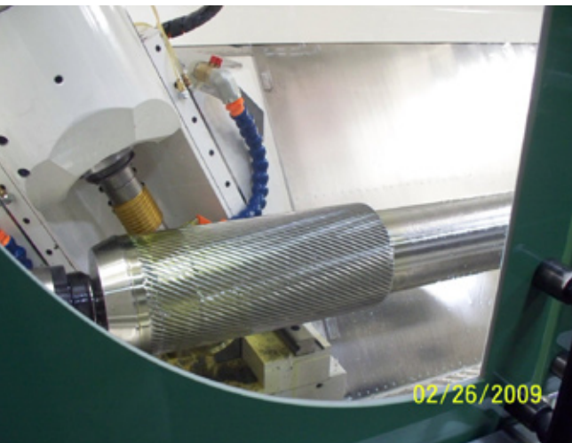
Die Wälzfräsmaschine 400H verfügt über einen speziellen CNC-Reitstock mit Servoantrieb.
