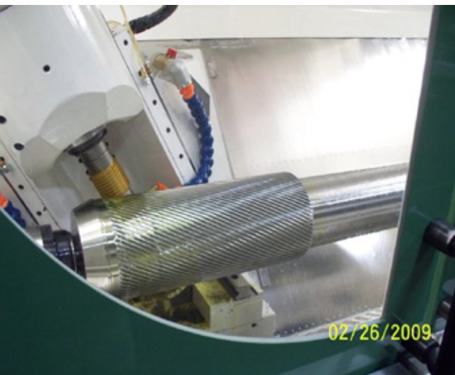
La tailleuse d'engrenages 400H est munie d'une contre-poupée unique en son genre commandée par servomoteur
