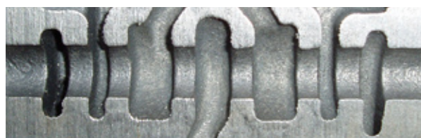
Un exemple typique de solution efficace d'un seul tenant offerte par UNIMERCO : un outil à rainurer les canaux et une pièce avant et après usinage
