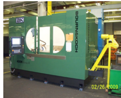
La tailleuse d'engrenages Bourn & Koch 400H série II a sept axes CNC
