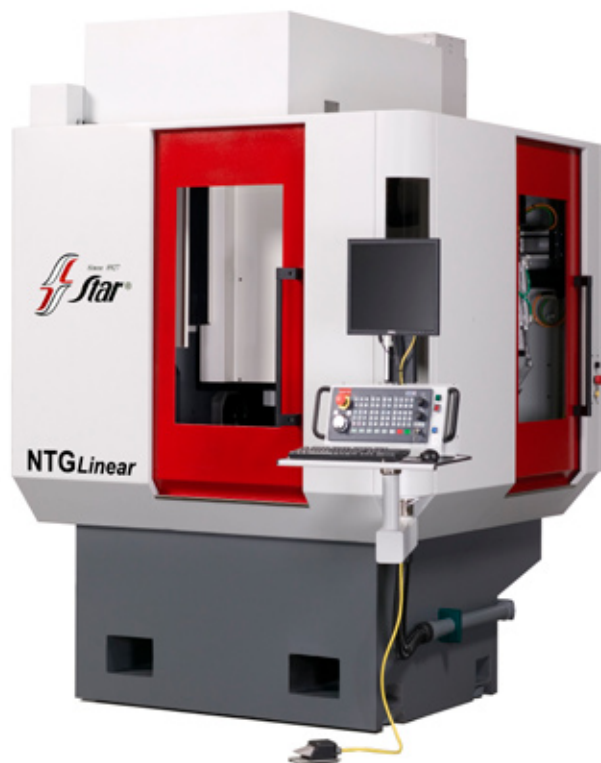
Les 8 axes de la nouvelle affûteuse NTG de la société Star Cutter sont commandés par un seul système CNC NUM
