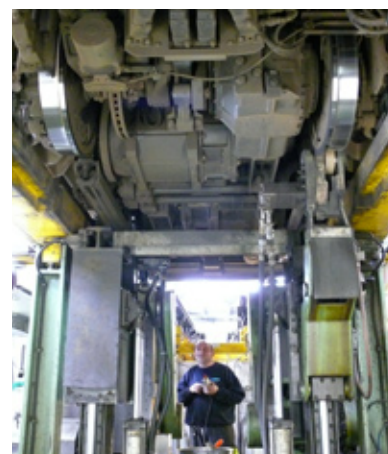
Tramway : le châssis de la bogie sur la machine
