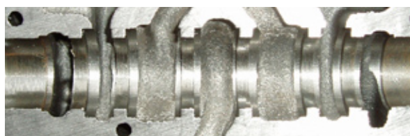
Un exemple typique de solution efficace d'un seul tenant offerte par UNIMERCO : un outil à rainurer les canaux et une pièce avant et après usinage
