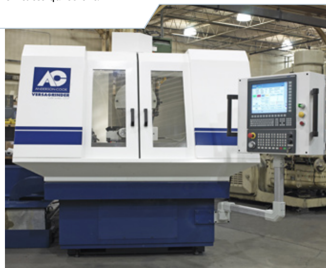
La nouvelle machine à affûter les outils d'Anderson-Cook, l'AC-Tru, utilise un système Power CNC triaxial NUM
