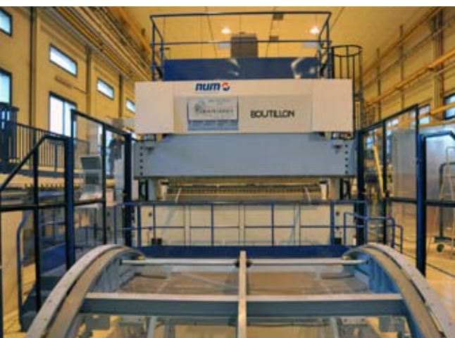
Vista del recipiente dopo la piegatura e del dispositivo di alimentazione in lamiera
