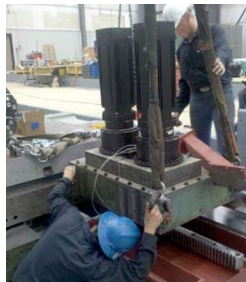
L'assemblaggio dei motori gestiti in tandem per mezzo degli azionamenti NUM MDLU3
