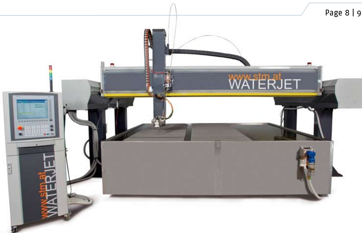
Sistema di taglio a getto d'acqua 3D STM nella struttura ponte con pannello comandi FS152i NUM
