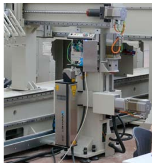
Laser per l'incisione di diversi tipi di codice (DATA MATRIX, CODICE A BARRE, CODICE DI TESTO ecc.)
