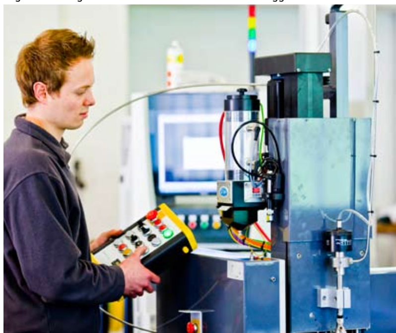
Regolazione degli assi della macchina durante il montaggio della macchina
