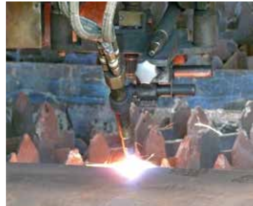
使用角切割功能的焰切割机
