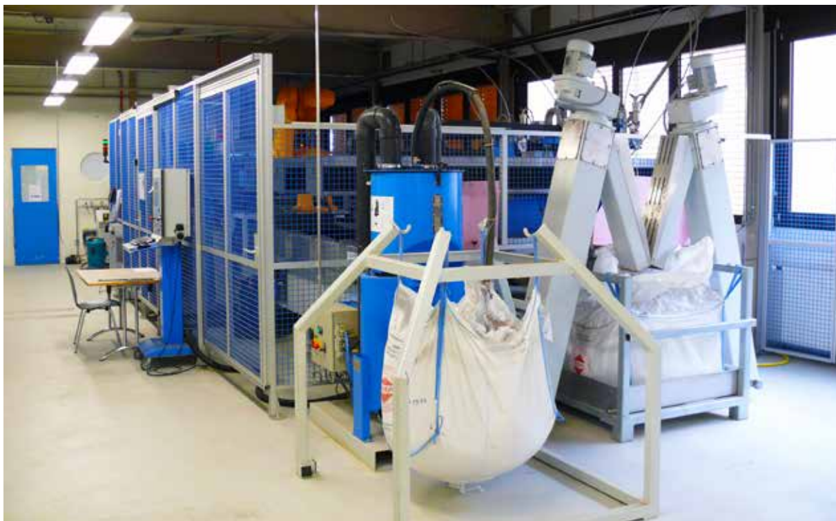
整套水刀切割机，显示了操作人员控制站和加工废物处理装置
