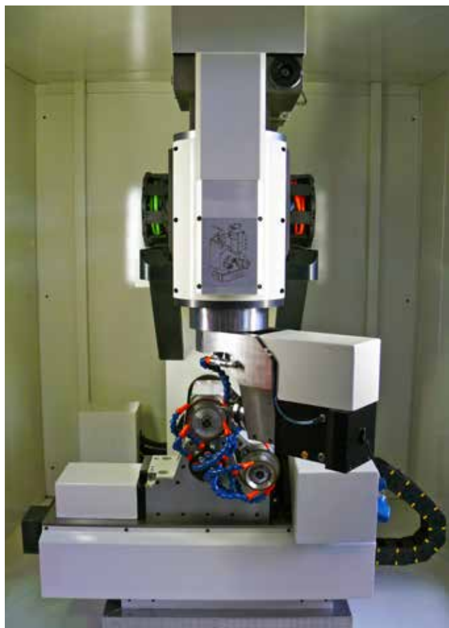
左侧：TG10 动力学实现了高稳定性和刚性，这是由于采用了紧凑设计和创新型垂直轴概念
