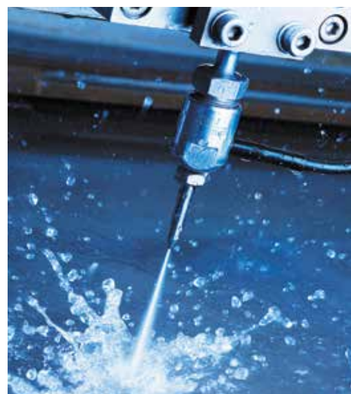
水刀切割机的高精度水射流
