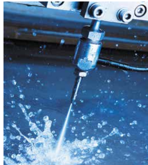
Hochpräziser Wasserstrahl einer Wasserstrahlschneidmaschine
