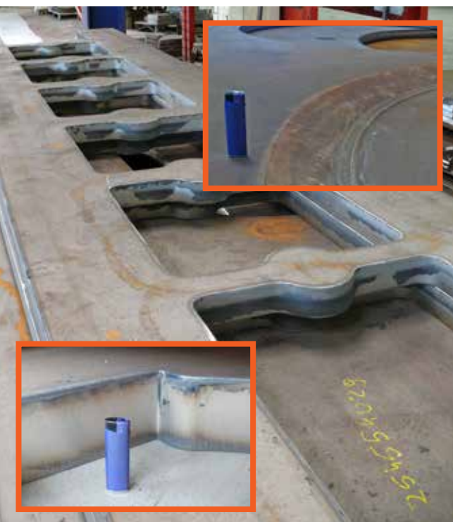
Grosses Bild: 120mm dickes, bearbeitetes Konstruktionsteil
