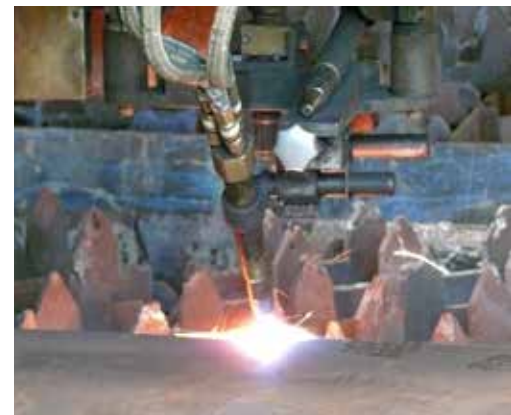
Brennschneider bei der Schrägschnittfunktion im Einsatz
