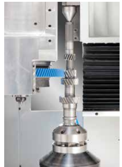
Eingangswelle eines Sportfahrzeuggetriebes, gehont mit Grono 250
