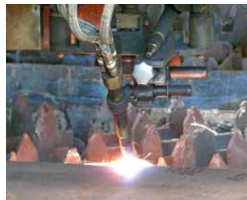
Machine de découpe au chalumeau, utilisée avec la fonction de coupe en biais
