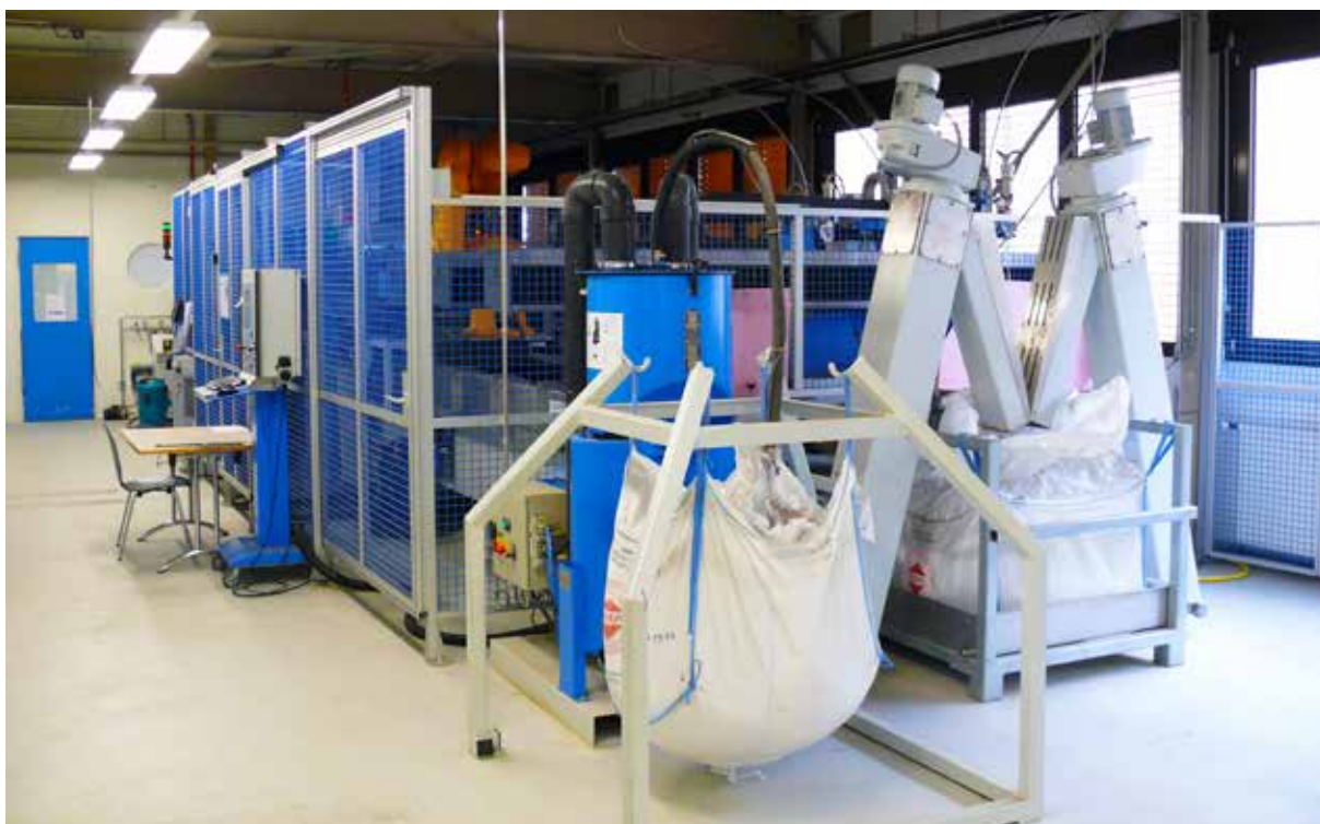
Machine de découpe au jet d'eau, avec processus de préparation du travail et d'élimination des déchets
