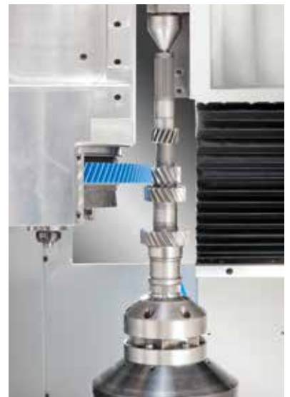
Arbre d'entrée de boîte de vitesses d'une voiture de sport, fini au pierrage avec la GRONO 250
