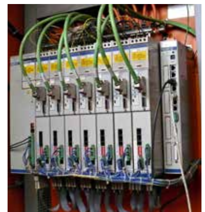
Oben: UP-Anlage beim Schweissvorgang - es werden die vorgegebenen Teachpunkte angesteuert Unten: NUM CNC Steuerung Flexium 68
