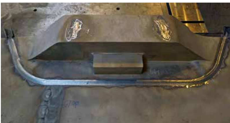
Links: Stahl- und Gussteile können mit der UP-Anlage qualitativ hochwertig verschweisst werden
