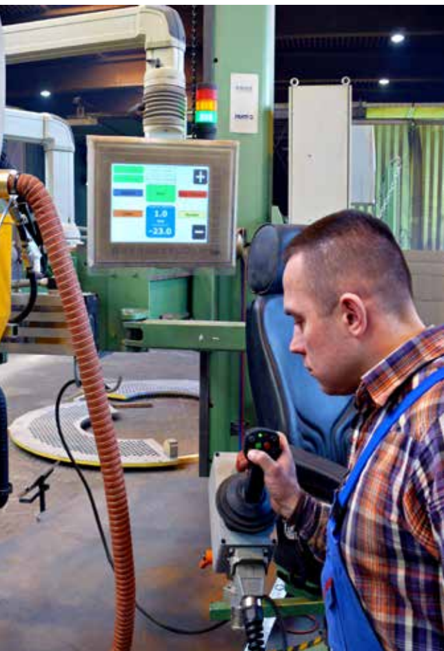
Oben: Bildschirm mit Joystick Unten: Arbeiter richtet mittels Joystick die Anlage für den Schweissvorgang ein
