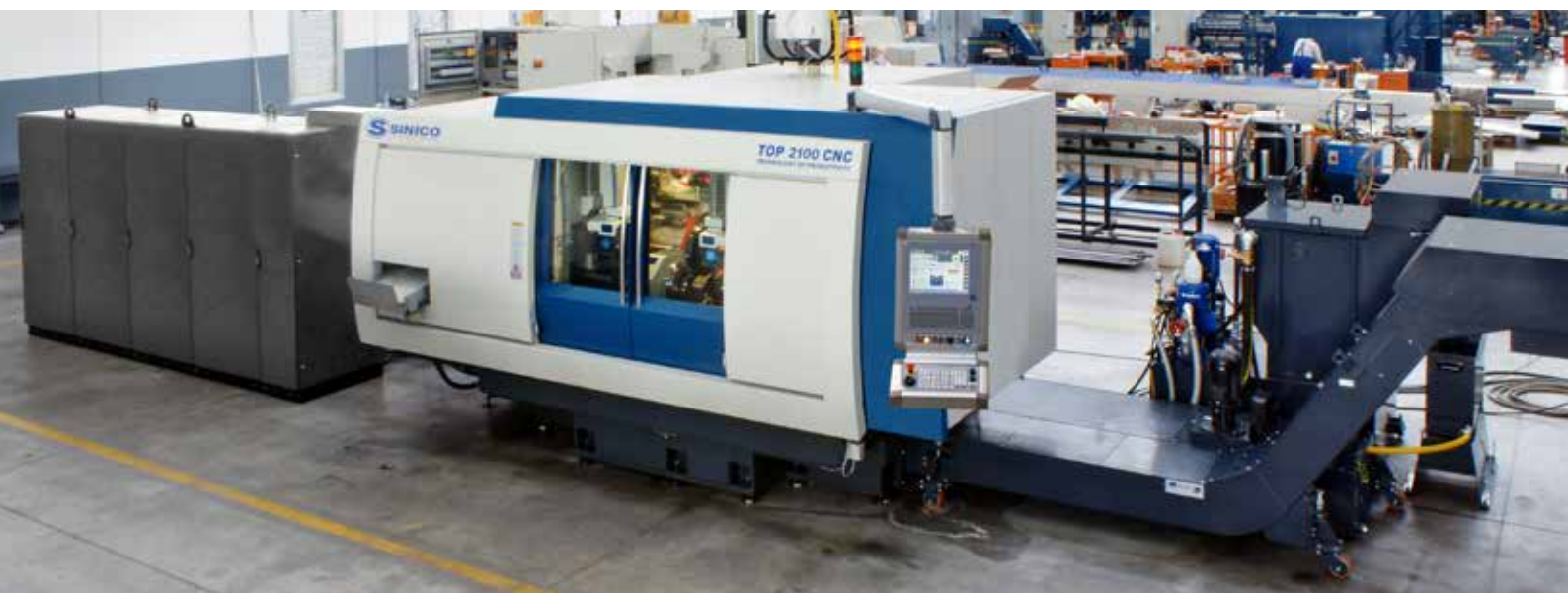
Unten: Die gesamte TOP 2100 CNC-Maschine mit der NUM Flexium CNC-Steuerung
