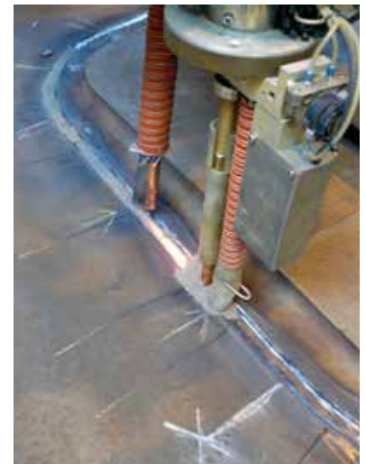
Oben: UP-Anlage beim Schweissvorgang - es werden die vorgegebenen Teachpunkte angesteuert Unten: NUM CNC Steuerung Flexium 68
