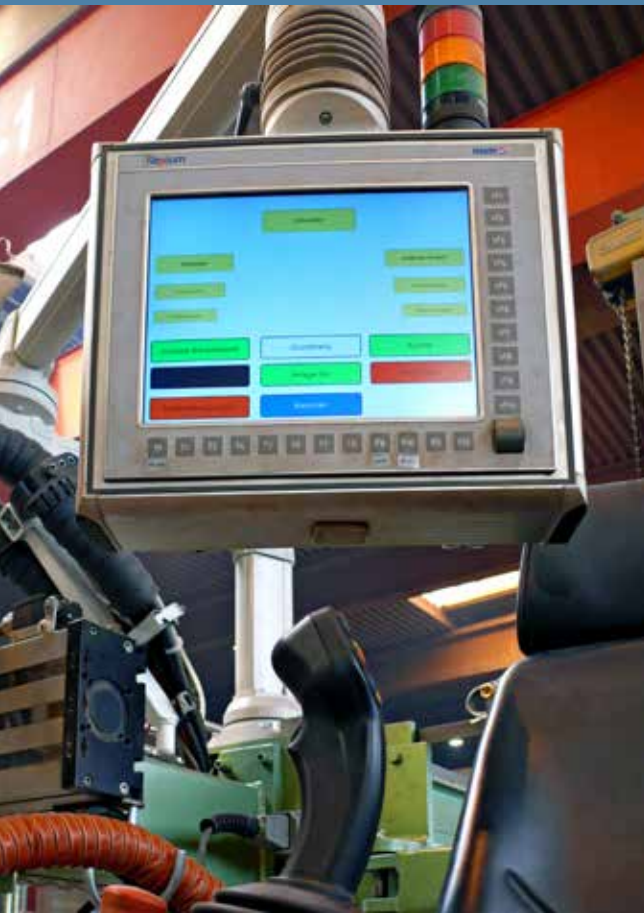
Oben: Bildschirm mit Joystick Unten: Arbeiter richtet mittels Joystick die Anlage für den Schweissvorgang ein
