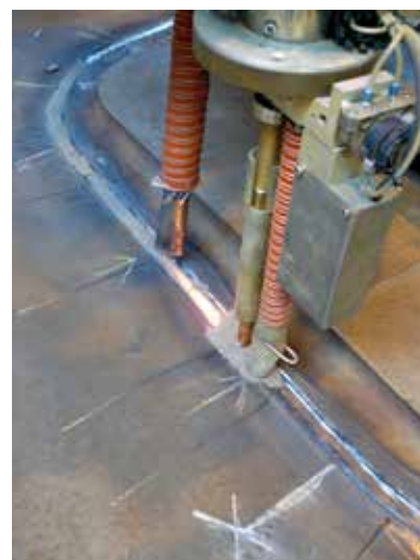
Haut : système SA pendant le soudage : le système se déplace aux points d'apprentissage prédéfinis Bas : système de commande numérique NUM Flexium 68
