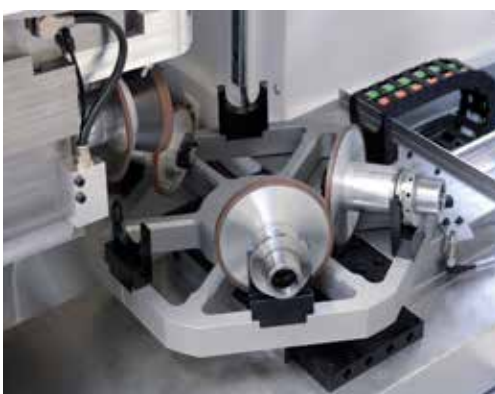
En bas : changeur d'outils à 6 positions
