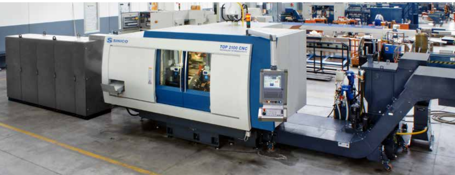
Ci-dessous : machine TOP 2100 complète avec le système de commande numérique NUM Flexium
