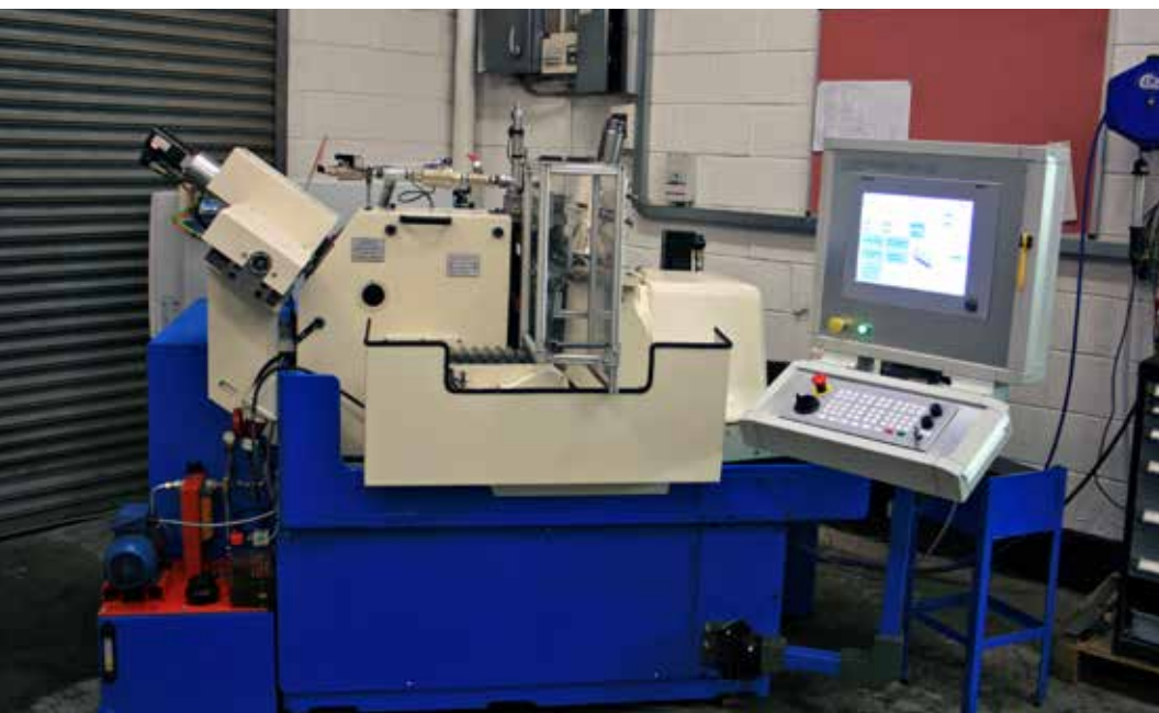
Haut : Rectifieuse Cincinnati 2-OM avec entraînement hydraulique qui a servi de base
