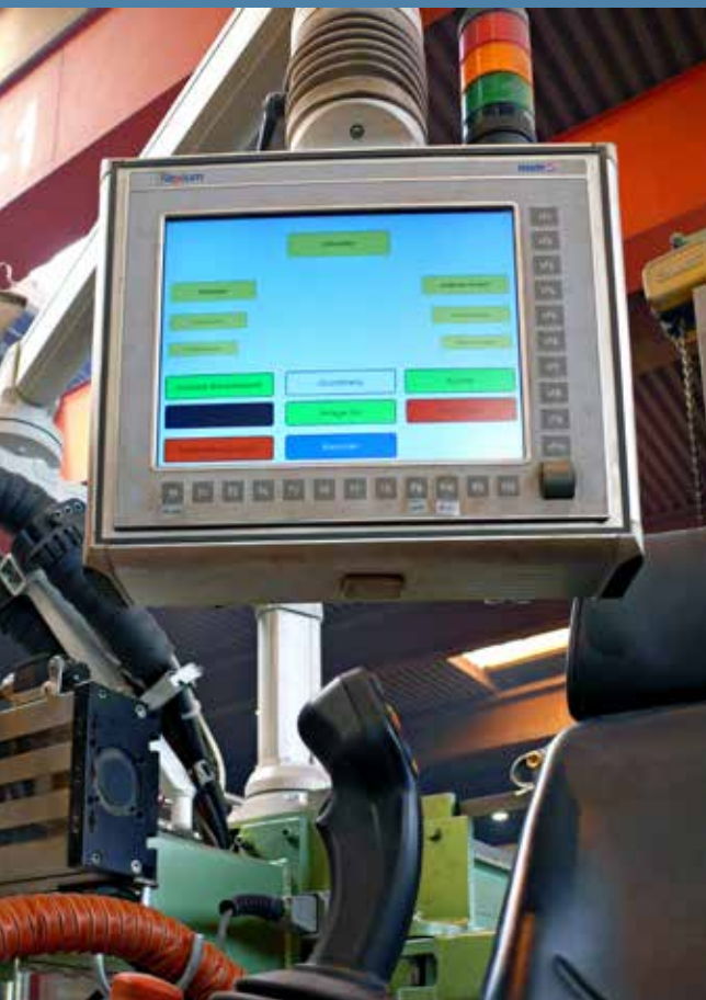
Haut : écran et manette de commande Bas : configuration du système pour le soudage en utilisant la manette de commande
