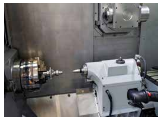
La zona di lavoro della Genymab con la contropunta e la tavola di fresatura sulla destra.
