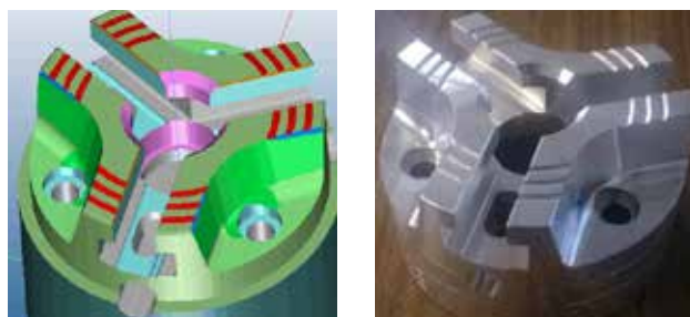
Funzione RTCP e piano inclinato (5 assi): Pezzo simulato e pezzo lavorato
