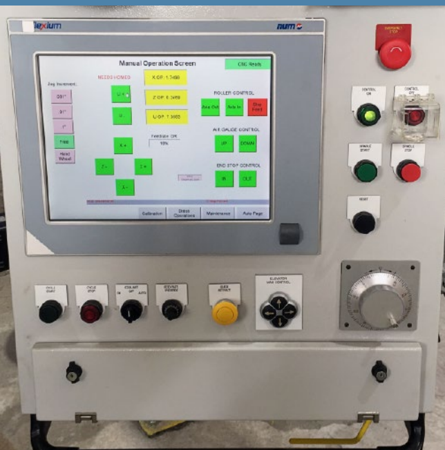
En haut: La nouvelle console de la machine inclut un tableau de commande Flexium avec écran d'affichage tactile.
