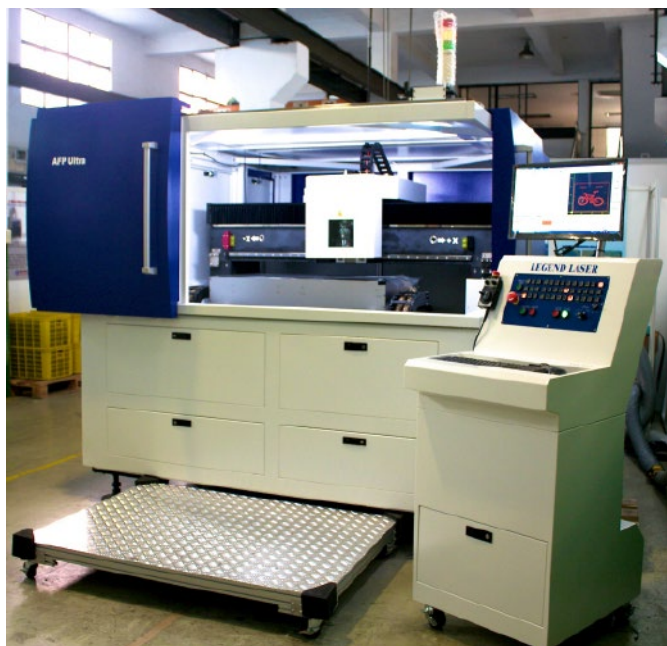
Das neue Präzisionsblechlaserschneidsystem SRC-610 von Legend Laser basiert vollständig auf der CNC-Plattform Flexium+ von NUM.
