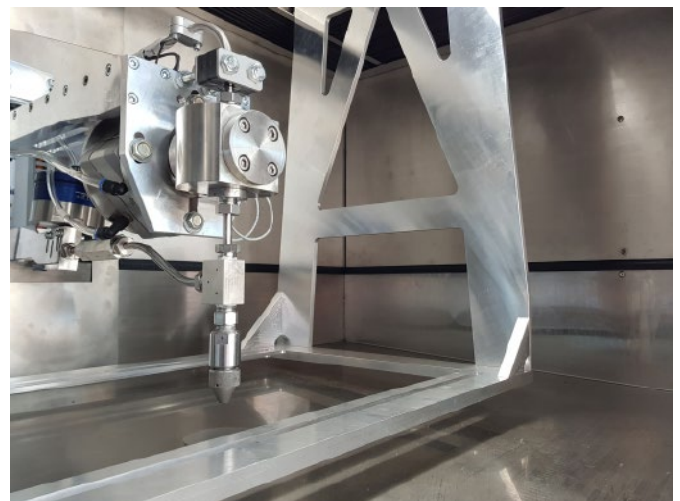
Arbeitsraum der NOVAJET-Wasserstrahlschneidanlage.
