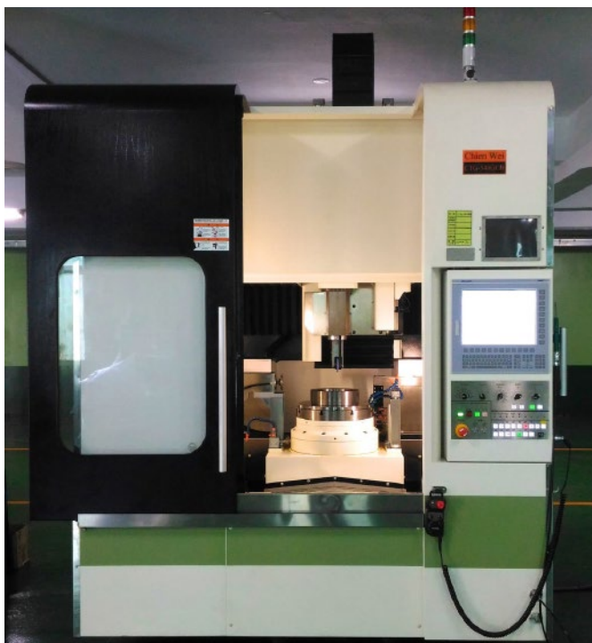
Die neue Verzahnungsschleifmaschine von Chien Wei basierend auf der neuesten Generation des Flexium + 68 CNC-Systems von NUM.
