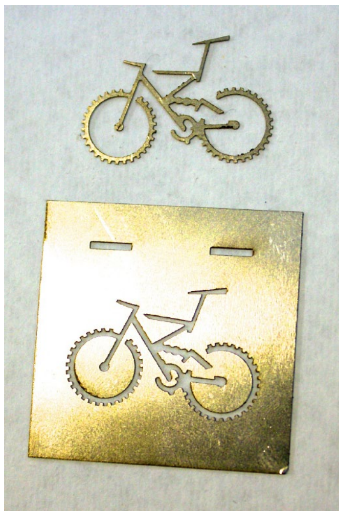
Das neue SRC-610-System von Legend Laser kann komplexe Blechteile mit einer Genauigkeit von plus/minus 10 Mikron schneiden.
