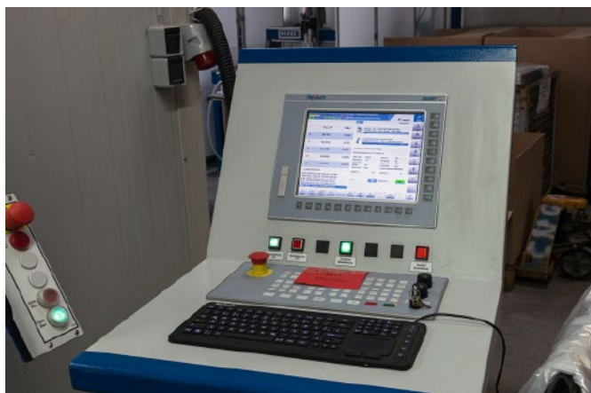
Abgesetztes Bedienpanel FS122 mit Maschinenbedienfeld MPO4 des NUM Flexium+ Systems.
