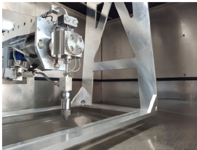
Zone de travail du système de découpe au jet d'eau NOVAJET.
