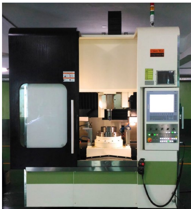
La nouvelle rectifieuse pour engrenages de Chien Wei est entièrement basée sur la dernière génération de la plate-forme CNC Flexium+ 68 de NUM.
