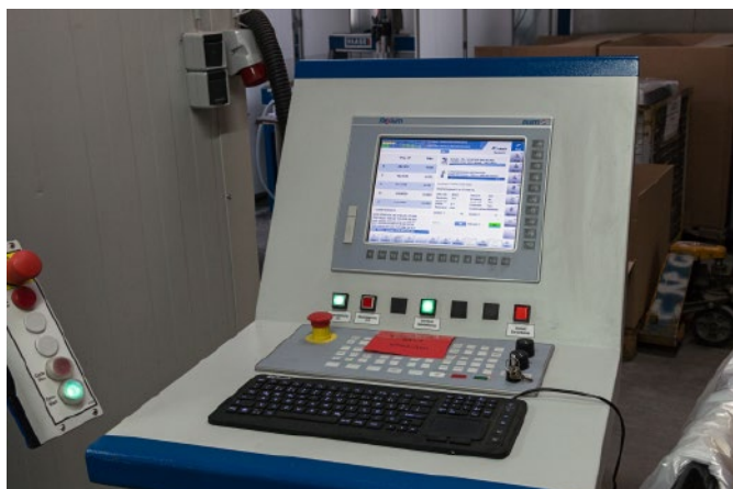
Pupitre opérateur déporté FS122 avec pupitre de commande machine MPO4 du système NUM Flexium+.
