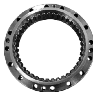
Une couronne intérieure après rectification de profil.
