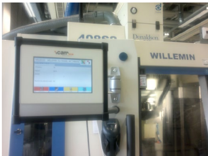
Terminal sur une machine CNC analogique pour la connexion à l'iCAMNet.
