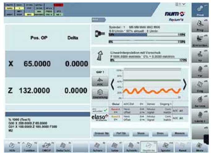
NUM Flexium+ 8 控制系统与 GAP 传感器集成
