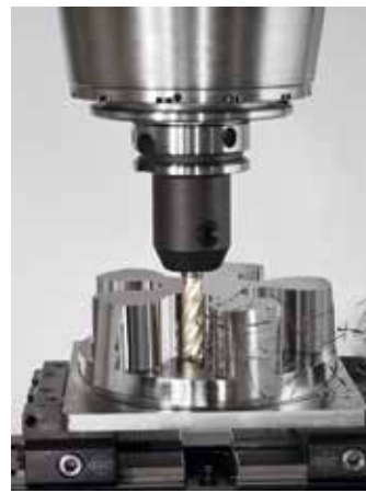
Walter Prototyp 的整体硬质合金铣刀 MD133 Supreme 正在使用中
