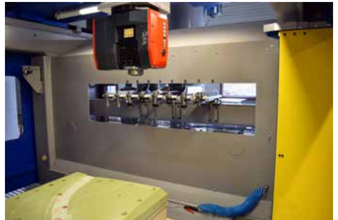
RTCP 头和右侧换刀装置的细节
