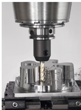
VHM-Fräser MD133 Supreme von Walter Prototyp im Einsatz
