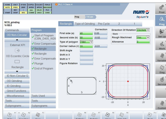
Software NUMgrind del sistema aiuta ad automatizzare completamente la rettifica non circolare
