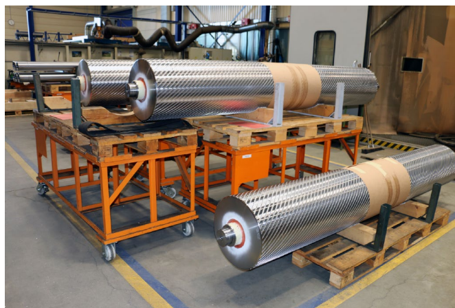
Rotoli dopo la lavorazione con la fresatrice per scanalature
