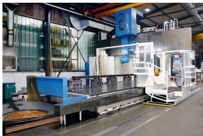
Centro di lavoro a portale Modumill con controllo CNC NUM Flexium+
