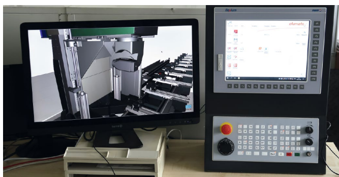
Nel sistema di messa in servizio virtuale di elumatec, tutti i componenti di controllo sono replicati virtualmente uno a uno
