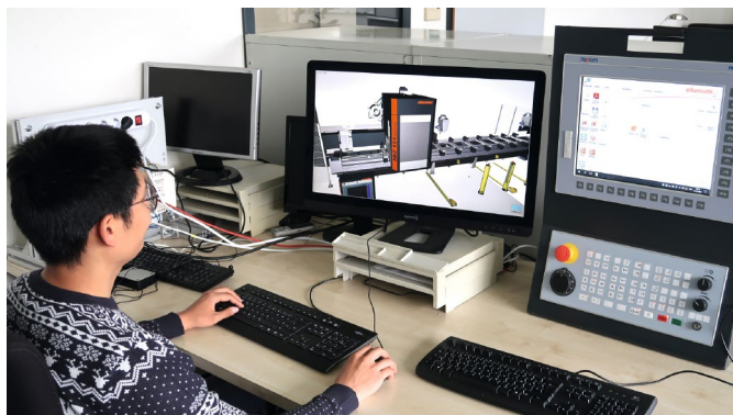
Un dipendente simula la lavorazione del profilo con un SBZ 151 con un profilo in posizione
