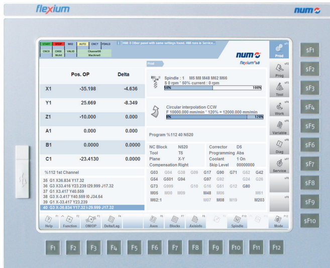
Bedienfeld mit 22 Funktionstasten (wird über die Codierung „F“ in der Bestellnummer gekennzeichnet)
