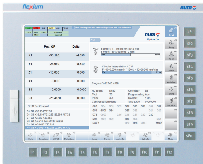
Pupitre avec 22 touches de fonction Référence avec codage du pupitre PC « F »
