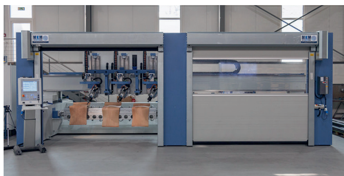
Innovativa fresatrice a 17 assi per sedute di sedie
