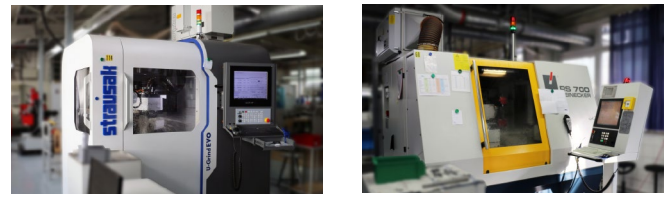
Werkzeugschleifmaschinen mit NUMROTO Software im Maschinenpark von ALMÜ
