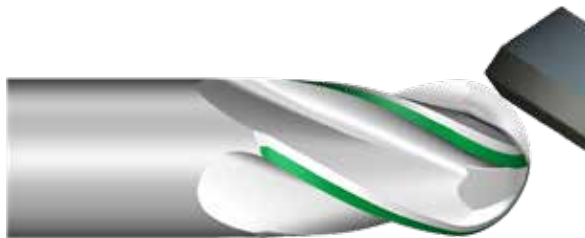
图 7 在 11V5 砂轮沿球形后角使用整个磨料进行磨削
