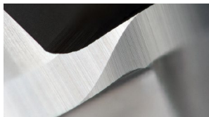
Figure 1 L'arête de coupe transversale mesurée avec le microscope numérique de Keyence (grossissement 200:1)
