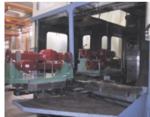
Fase di orientamento automatico dei pallet
