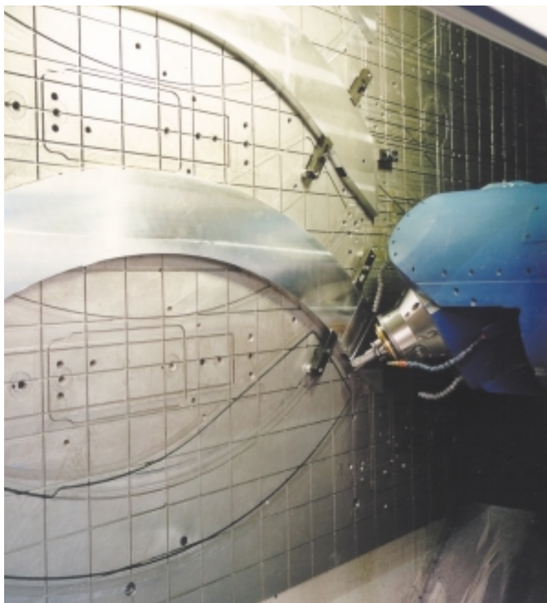
Foto: Forest Liné - Macchina Aerostar a 5 assi
