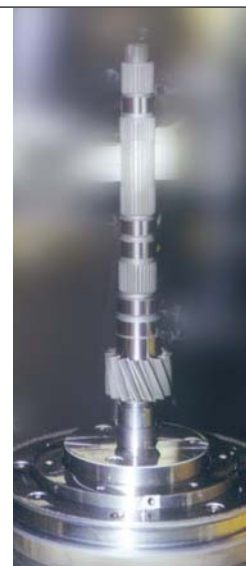
Exemples de plusieurs engrenages sur un même arbre.
