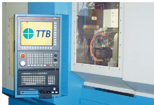
TTB Engineering réalise des centres d'affûtage d'outils 5 ou 6 axes pour la production d'outils de petites tailles ( \varnothing 12 à 0,02 mm).
