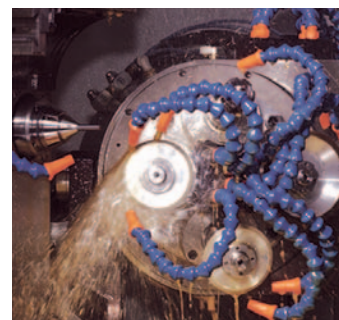
Montati su una tavola girevole, i supporti possono portare 3 mole ognuno. Associato al dispositivo portapezzo a 4 assi, questo sistema a più supporti mole è in grado di eseguire un'operazione di rettifica cilindrica senza smontare il pezzo.
