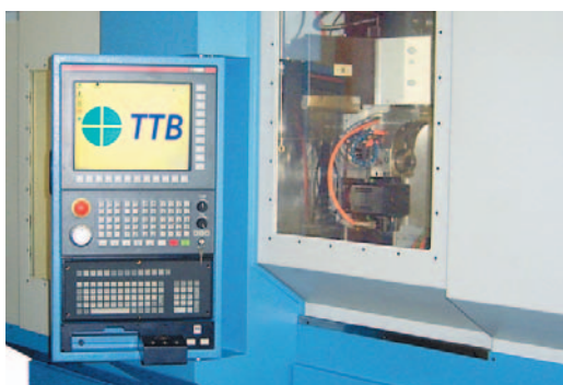
TTB Engineering realizza centri di affilatura utensili da 5 o 6 assi per la produzione di utensili di piccole dimensioni ( \varnothing 12 - 0,02 mm).
