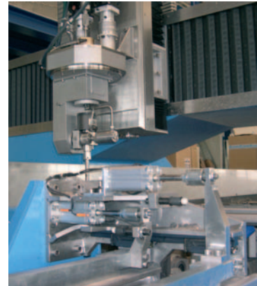
Eine dreidimensional schneidende Wasserstrahlanlage wurde im Auftrag der Firma Metzeler, einem Automobilzulieferer aus Deutschland entwickelt
