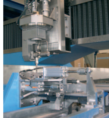
Installation tridimensionnelle de découpe par jet d'eau, développée pour Metzeler, un équipementier automobile allemand
