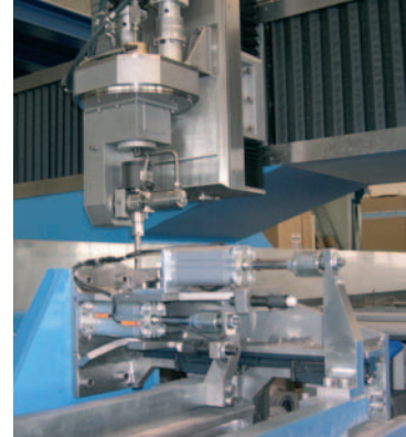
Impianto tridimensionale di taglio a getto d'acqua, sviluppato per Metzeler, un fornitore tedesco di componenti per autoveicoli
