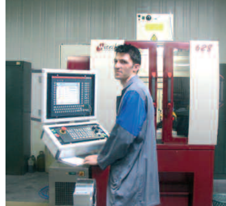
La macchina Witech 628 è un centro di lavoro a 5 assi particolarmente adatto alla realizzazione di pezzi di altissima precisione.
