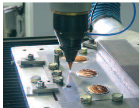
La macchina Witech 628 è un centro di lavoro a 5 assi particolarmente adatto alla realizzazione di pezzi di altissima precisione.
