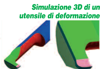
Simulazione 3D di una fresa sagomata con profilo frontale
