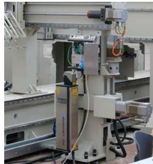
Dispositif laser permettant d'imprimer différents codes (MATRICE, CODE-BARRE, CODE DE TEXTE, etc.)
