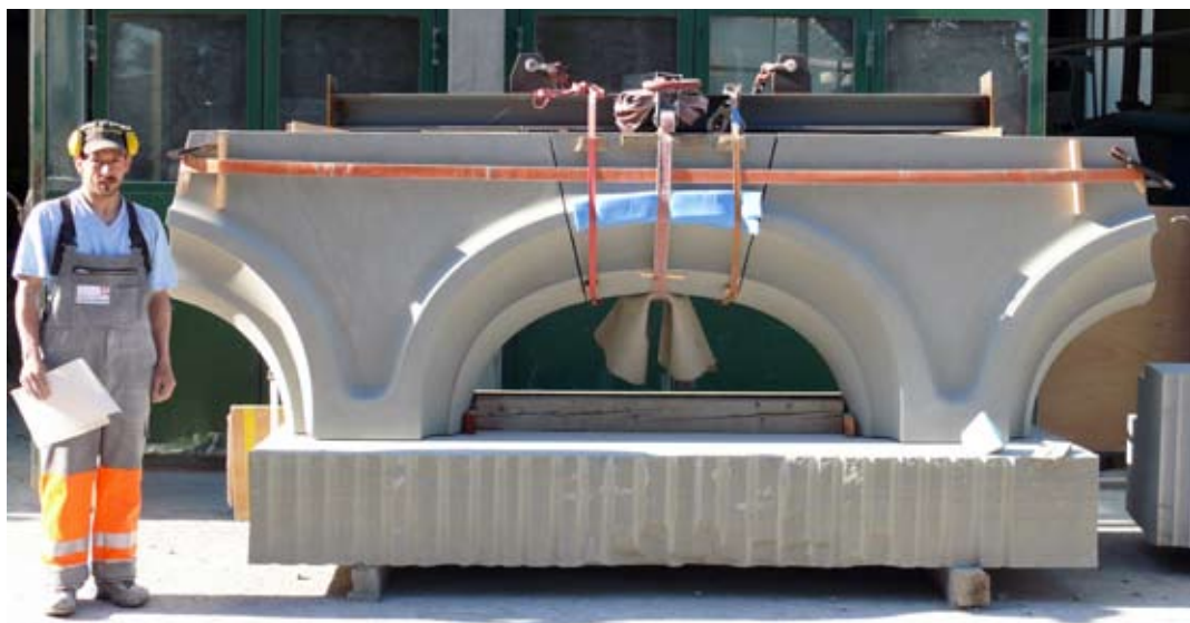
Finition d'une voûte d'arcade
