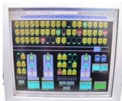
Sopra: Supervisore gestione pallet delle 3 macchine CNC di MCM
