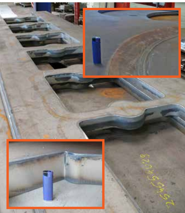
Immagine grande: Elemento della costruzione lavorato dallo spessore di 120mm
