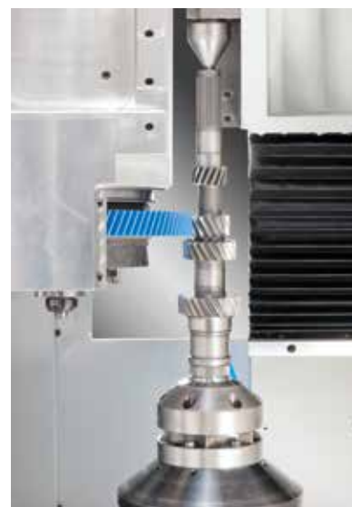
Albero d'entrata di una trasmissione di un'auto da corsa lavorato con GRONO 250
