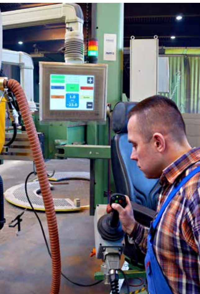
Sotto: operaio che imposta il sistema per il processo di saldatura utilizzando il joystick
