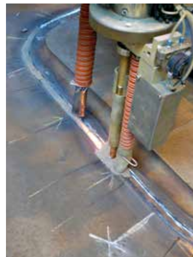
Sopra: sistema SA durante il processo di saldatura; il sistema si sposta sui punti di istruzione predefiniti
