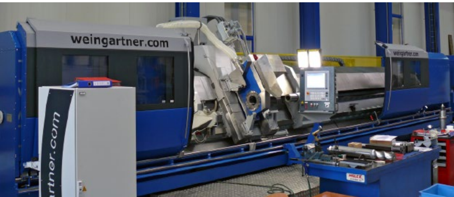
下图：Weingärtner Maschinenbau GmbH 的 Vario 生产机床，配备了 NUM Flexium CNC 系统
