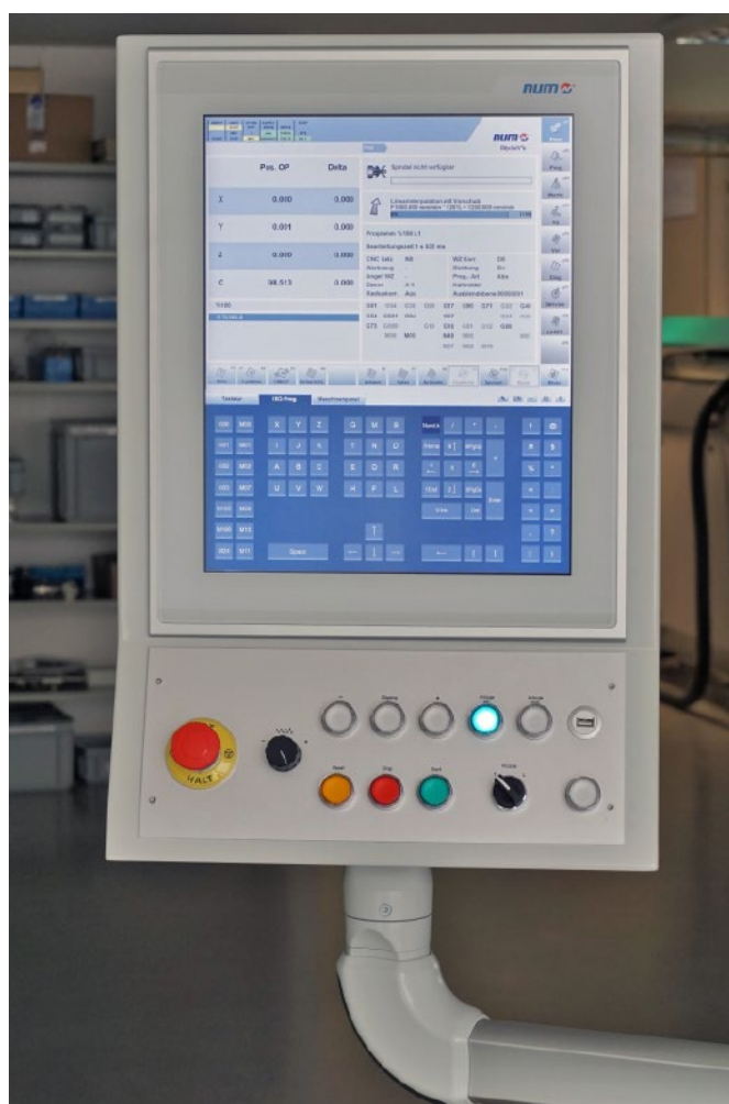
HMI FS192i di NUM integrata con un pannello di controllo sviluppato internamente da Felastec.
