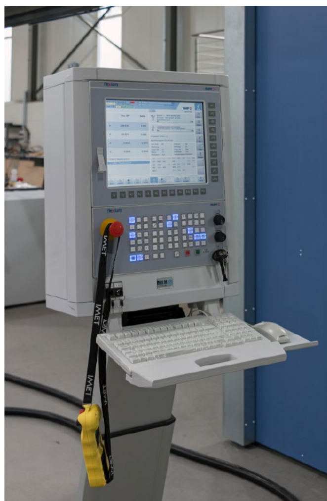
Unità di controllo Flexium+ 68 corredata di una HMI FS153i e di un pannello di comando MPO6 di NUM.
