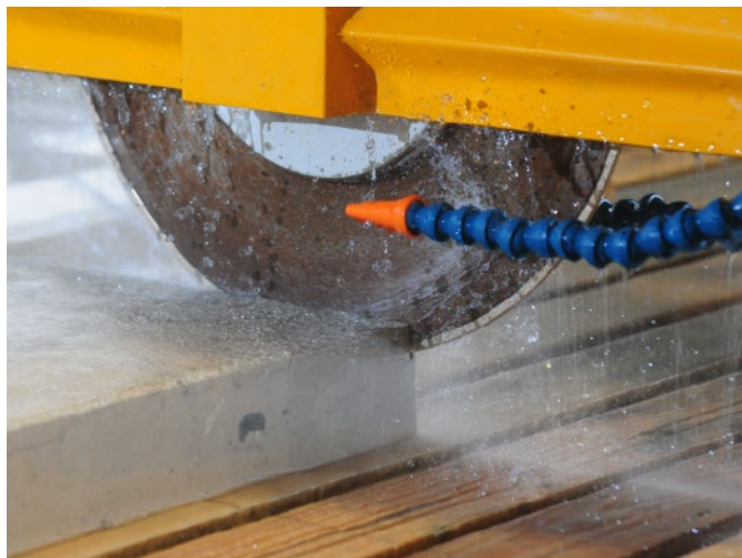
La lama taglia la pietra fino a 650 giri/min e ha un diametro fino a 1,3 m.
