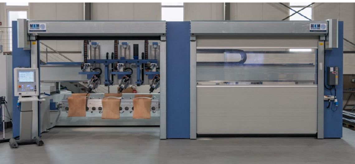
Fresatrice uni_portal DT nel capannone di montaggio presso MKM, poco prima della consegna. Le macchine di MKM vengono assemblate presso la sede del cliente finale dalle stesse persone che le montano presso MKM.
