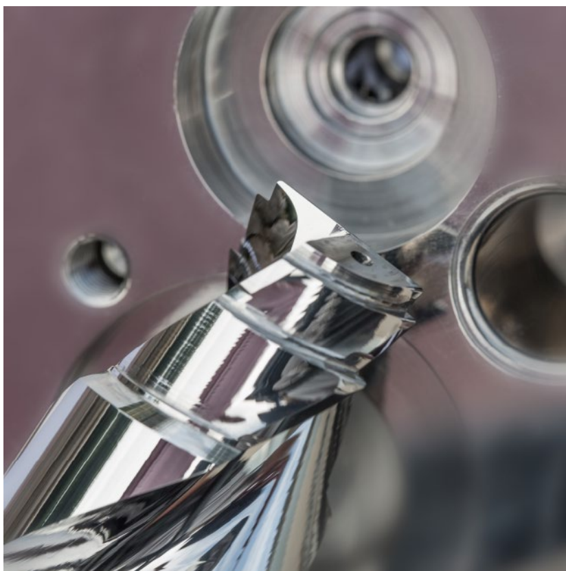
Un utensile speciale prodotto, lucidato e rivestito da HAM (trapano a gradini con diverse fasi di forma) in base alle esigenze del cliente.
