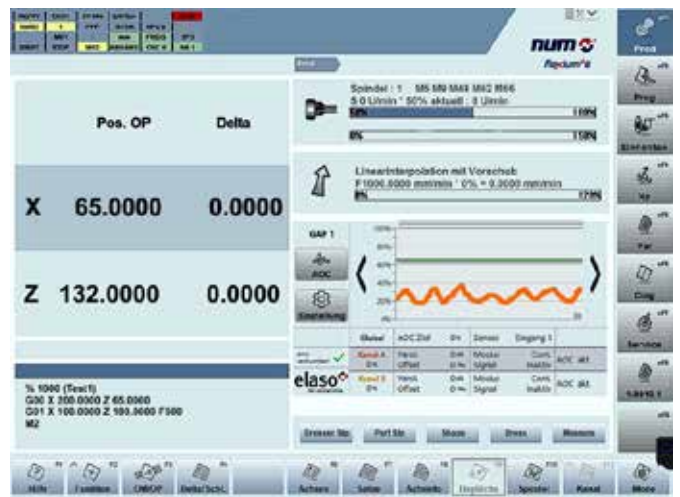
NUM Flexium+ 8 控制系統與整合 GAP 感應器的畫面
