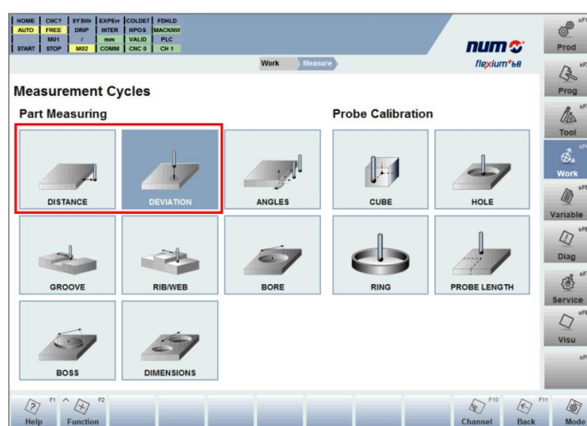
Il nuovo software grafico di NUM che consente agli operatori di macchine utensili CNC di gestire facilmente le misure di tastatura di pezzi e utensili
