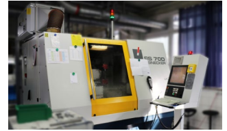
Werkzeugschleifmaschinen mit NUMROTO Software im Maschinenpark von ALMÜ
