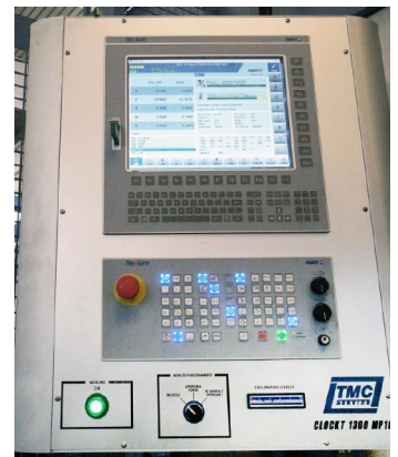
Bedienfeld mit der CNC NUM Flexium+ 68, installiert auf dem Bearbeitungszentrum Tank 1300 MCM
