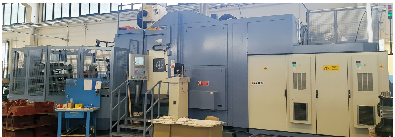
Tank 1300 MCM Bearbeitungszentrum 4 Achsen, 10 Paletten und 400er-Werkzeugmagazin
