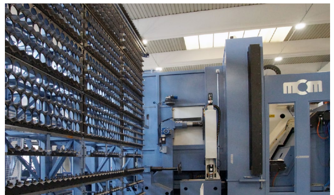
Das Magazin des Tank 2600 ist für die Aufnahme von 1200 Werkzeugen ausgelegt
